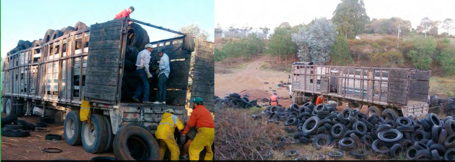
Desalajo de neumáticos usados acopiados en los centros de acopios intermunicipales de la SIMAR Sureste, para su transporte y tratamiento en hornos de cemento como combustible alterno.
